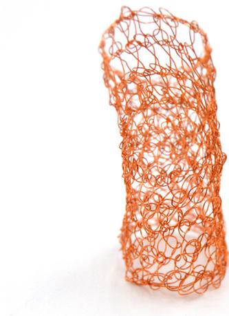
Avec le même fil de cuivre, réalisation d'un tube en maille serrée à l'aide de la technique du crochet. Le tube a les mêmes propriétés que l'échantillon précédent.
